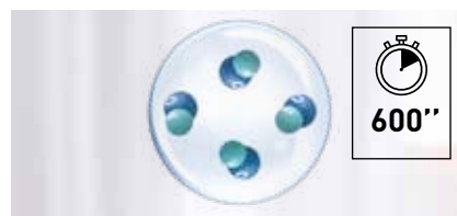
nanoe™ X-Partikel: von Wassertröpfchen umschlossene Hydroxylradikale
